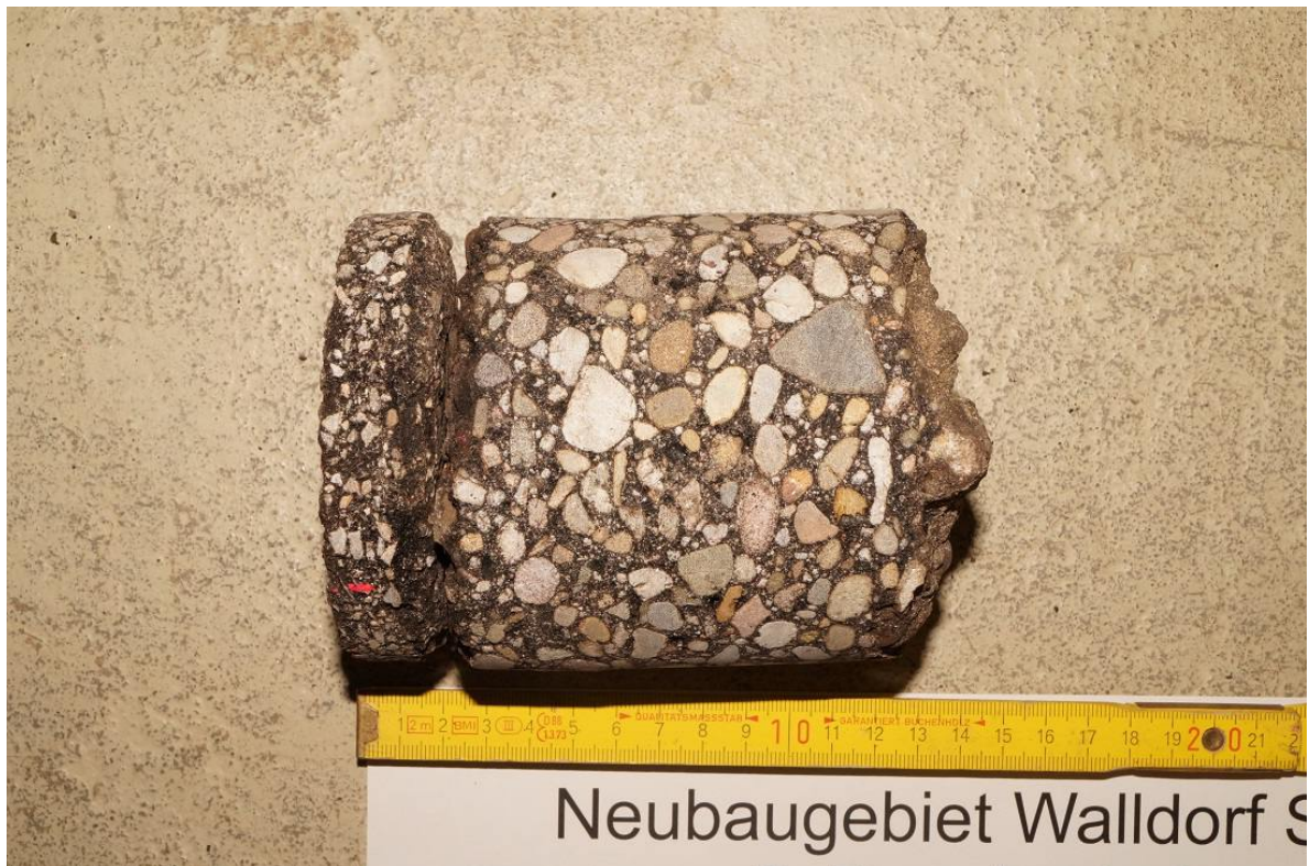
Bild 12: Detailaufnahme Asphaltkern KB 5
