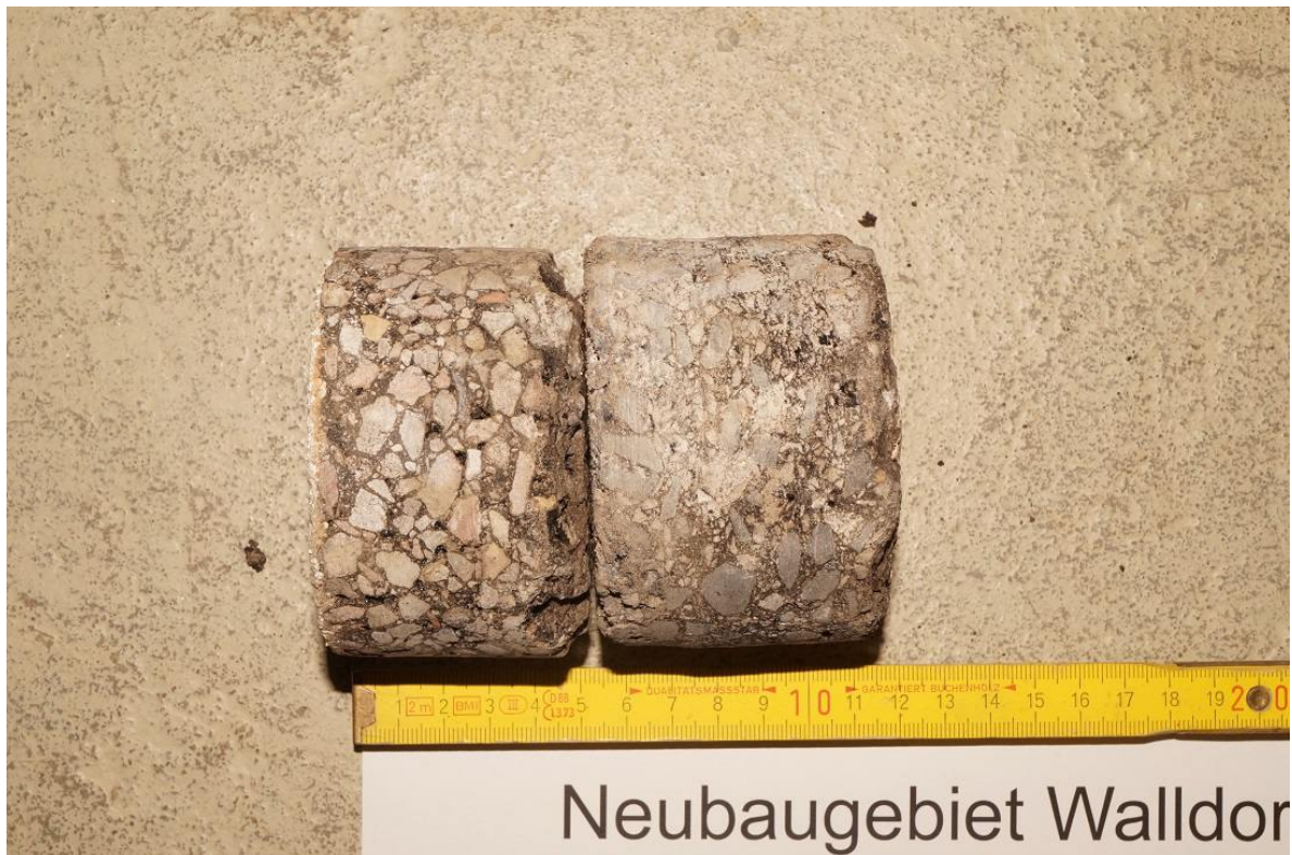
Bild 8: Detailaufnahme Asphaltkern KB 2
