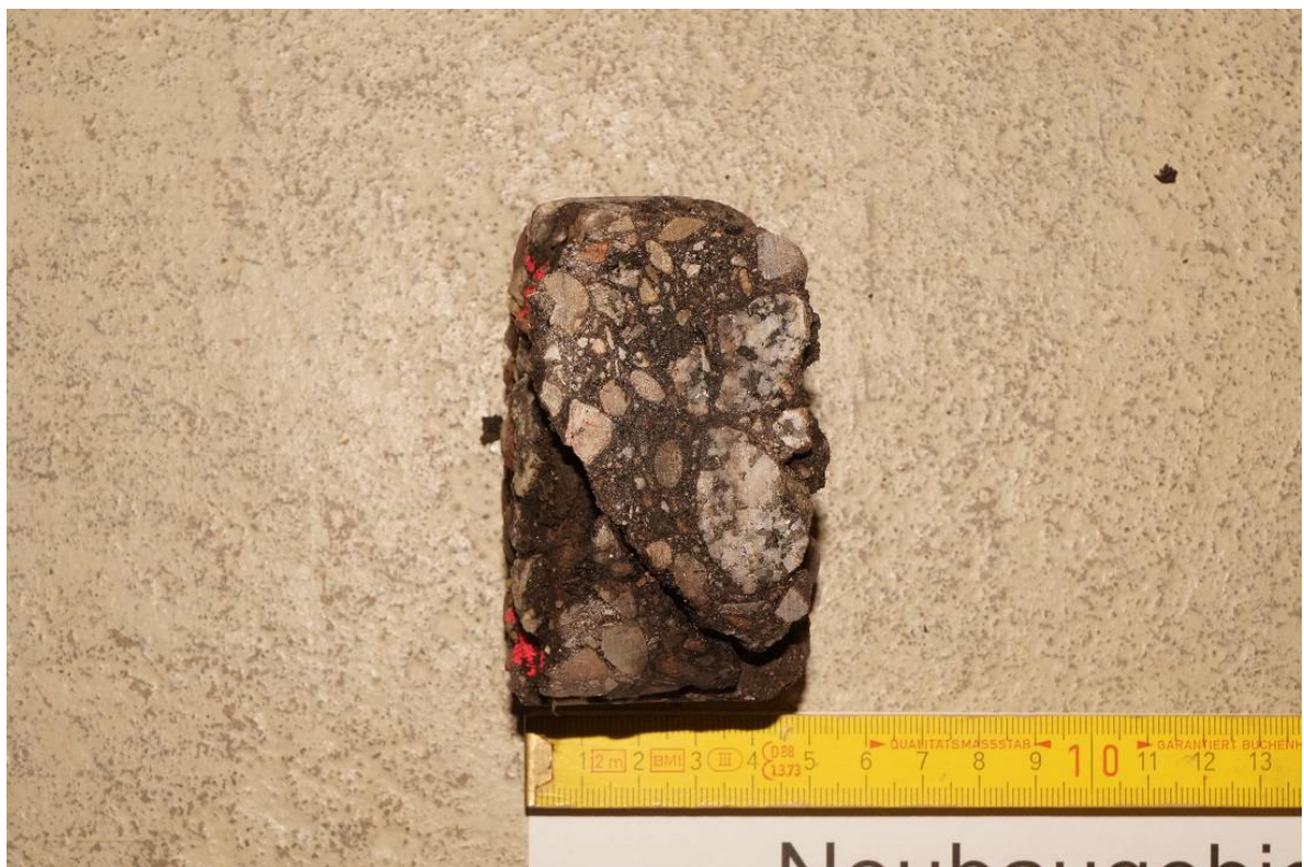
Bild 2: Detailaufnahme Asphaltkern KRB 29
