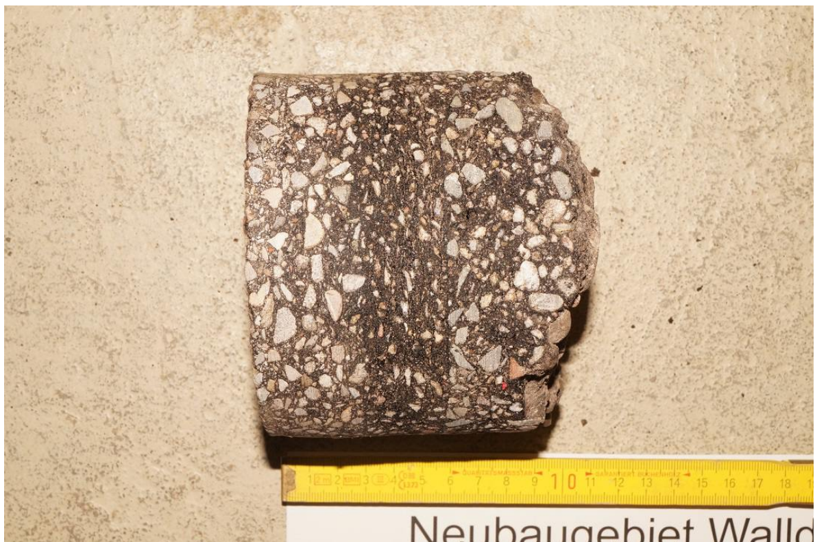
Bild 14: Detailaufnahme Asphaltkern KB 6
