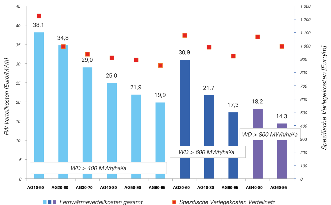
Abbildung 20: Beispielhafte Wärmeverteilkosten in Wärmenetzen (FW) mit spezifischen Investitionskosten der Netze, dargestellt am Beispiel einer Großstadt (siehe Abbildung 18). WD: Wärmedichte, AG: Anschlussgrad.
