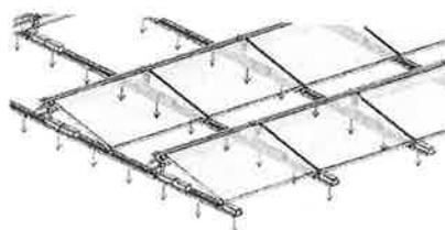
Linienlast [ $kg/m$ ] inkl. Schneelast unter der Grundschiene zur Überprüfung der Gebäudestatik (z.B. Trapezblech)
