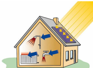
Solarthermische Anlagen: Gewinnung von Wärme für die Warmwasserbereitung und Heizung
